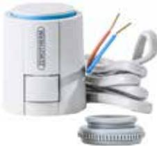
**Leistungsmerkmale:** • Ausführung in stromlos-zu (NC) • 1 Watt Leistungsaufnahme • Vollständige Kompatibilität zum Ventil-Adaptersystem • Einfache Steckmontage • 360° Montagelage • Patentierter 100 %-Schutz bei undichten Ventilen • „First-Open“-Funktion • Geringe Installationshöhe (57,3 mm) • TÜV-zertifiziert, CE-konform • Schutzart IP 54 • Rundum-Funktionsanzeige • Überspannungsgarantie.
