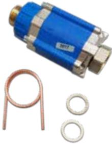
**Technische Merkmale:** • Max. Druck 10 bar • Betriebstemperatur 5 - 80 °C • Max.  $\Delta p$  2 bar • Einstellbereich 15 - 50 kPa • Kvs-Wert 5,6 • Max. Durchflussmenge 2.500 l/h • Materialangaben: Obere und untere Kappe Messing CB753S • Ventilkörper PA6 + 30 % FV • Feder AISI302 • Ausgleichsstößel Messing CW617N • Absperrschieber Noryl • Handrad ABS • Gewicht 1,2 kg
