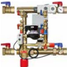
**Technische Merkmale:** • Max. Betriebstemperatur: 90 °C • Max. Umgebungstemperatur: 40 °C • Max. Betriebsüberdruck: 6 bar • Min. Temperaturdifferenz IT, Systemvorlauf  $\geq$  15 K • Temperatur Regelbereich: 30 - 50 °C • Werkseinstellung der Vorlauftemperatur: 44 °C • Werkseinstellung Temperaturbegrenzer: 55 °C • Nennwärmeleistung: ca. 10 kW (abhängig von Volumenstrom (Pumpenauswahl), Rohrnetzkenlinie und Temperaturspreizung).
