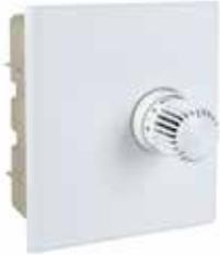
In Kombination von Radiator- und Flächenheizung wird die Multibox zur rücklauftemperaturabhängigen Regelung der Flächenheizung eingesetzt. Die Multibox besteht aus einem Wandeinbaukasten mit vormontiertem RTL-Ventilblock mit außenliegendem RTL-Kopf, Bauschutzabdeckung, Entlüftungsventil und Wandabschlussblende. Der Ventilblock hat 3/4" AG (Eurokonus) für rohrseitigen Anschluss mittels Klemmverschraubung. Einfache Montage.
